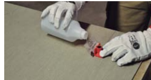
ES Se aconseja redondear el ángulo interno realizando previamente un orificio con un taladro y una broca adecuada para porcelánico (refrigerada con agua).
