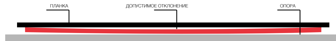
Конфигурация для правильного измерения изгиба
