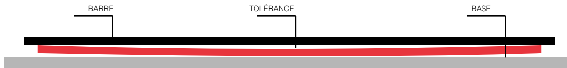
Configuration pour la mesure correcte du gauchissement
