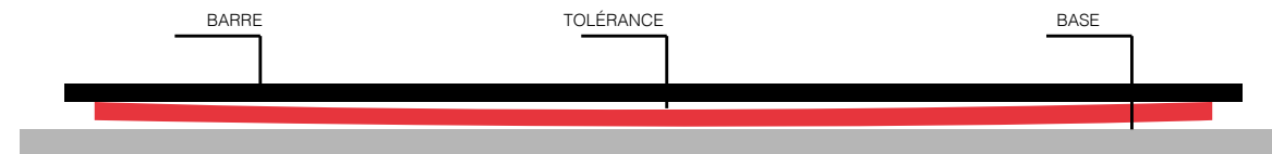
Configuration pour la mesure correcte du gauchissement
